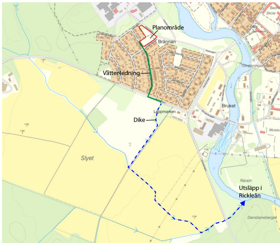
Figur 6. Befintliga dagvattenledning och diken som leder vatten till Rickleån.
